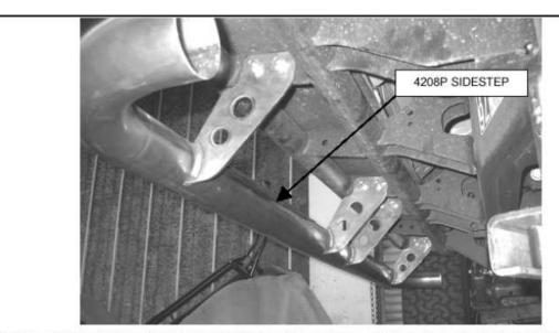
STEP 3. ATTACH 4208P SIDESTEP, TO THE ROCKER PANEL BAR, USING THE 7/16" FASTENERS AS SHOWN.
