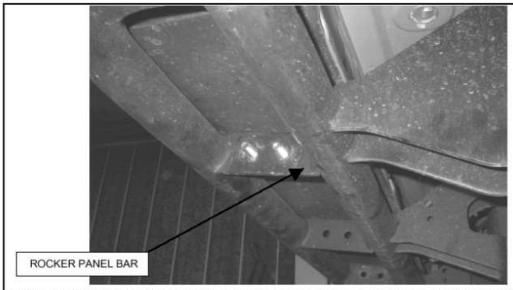
STEP 2. BEGIN THE INSTALLATION WITH THE PASSENGER SIDE. LOCATE THE HOLES IN THE ROCKER PANEL BAR, USED TO ATTACH THE FACTORY SIDESTEPS AND ACCESSORIES.
