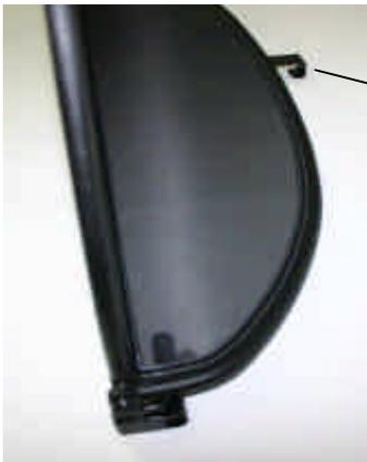
Das Windschott im Fond einhaken und waagrecht im Fahrzeug ausrichten. (ca. 3 cm von der Oberkante der Seitenverkleidung, sowie von hinten nach vorne ca. 26,5 cm) Position für die seitliche Bohrung anzeichnen. Bohrstelle vor dem Bohren ausschneiden! (Textile Seitenverkleidung) Nachdem die Löcher gebohrt wurden die, Hülsen in der Verkleidung anbringen!
